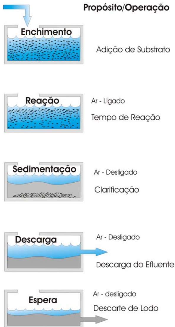
FIGURA 7 Diagrama esquemático do reator em batelada sequencial (RBS) operando no processo de lodo ativado (METCALF & EDDY, 2003).
